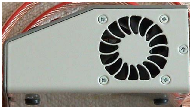
Prawa strona: wycięte laserem wlot wentylatora
