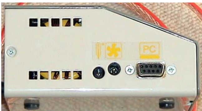
Lewa strona: podłączenia do czujnika temperatury, wentylatora do chłodzenia akumulatorów i podłączenie do PC
