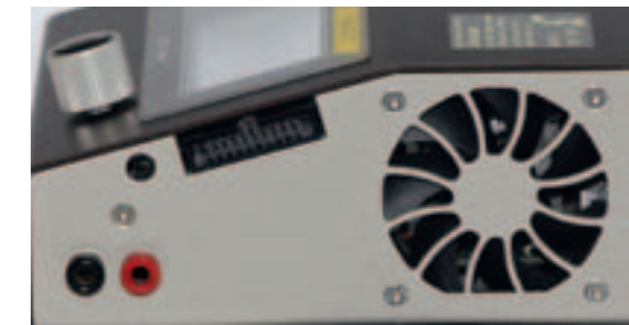
Auf der rechten Gehäusesseite sind die Ladeanschlüsse, der Balanceranschluss und der Lüfter ist zu erkennen
