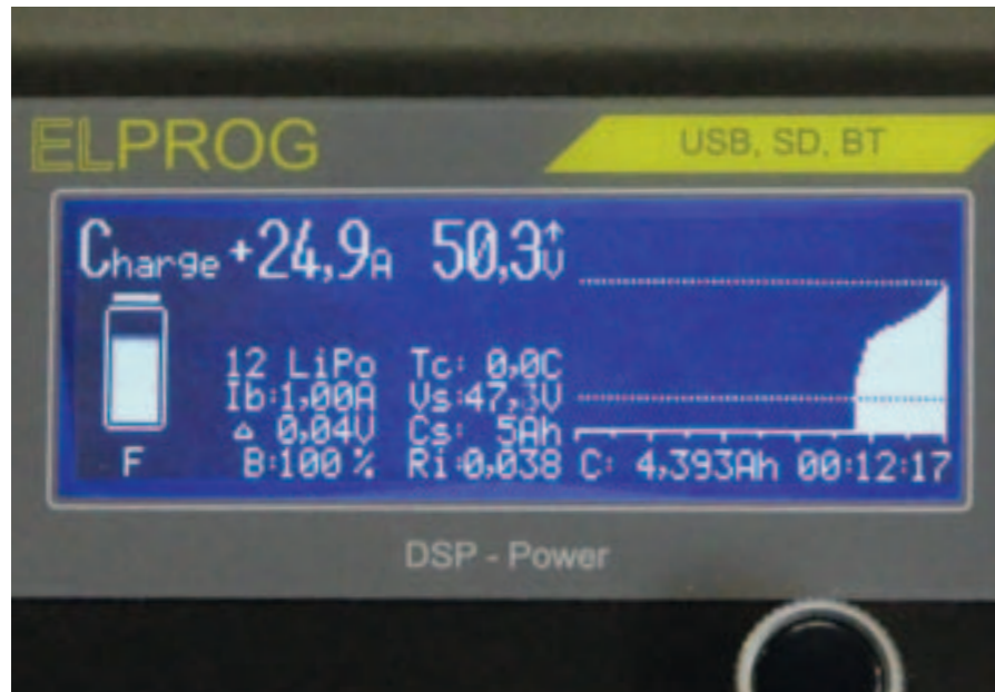
Mit 5C-Laderate (5.000 Milliamperestunden) bei knapp 1.300 Watt Ladeleistung geht es hier zur Sache. Die Infos des Display: „F“-ast-Ladung, 12s-LiPo, Balancer maximal 1 Ampere, Differenz zur Zeit 0,004 Volt, Balancer-Aktivität 100 Prozent, Netzteilspannung 47,3 Volt, entnommene Kapazität 5 Amperestunden, Akkuinnenwiderstand 0,038 Ohm, eingeladene Kapazität 4.393 Milliamperestunden und benötigte Zeit 12:17 Minuten
