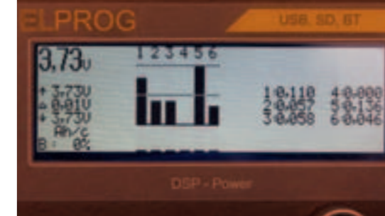
Eine Demonstration zur Genauigkeit der Balanceranzeigen. Bei der Entladung (helles Display), mit aktivierten Balanceraktivitäten, werden bis zu 0,136 Amperestunden (Z5) ausgeglichen. Was passiert jetzt beim Laden (dunkles Display)? Richtig: der Energiehaushalt zu den Balancerstufen zeigt ein exaktes Spiegelbild. Z5 beim Entladen = 0,136 Amperestunden, beim Laden jetzt 0,0 Amperestunden, und so weiter
