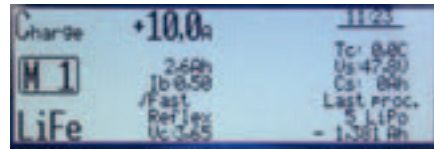
Das Standardmenü mit den Infos: Laden, Speicher 1, LiFe-Akku, 10 Ampere Ladestrom, 2,6 Amperestunden Akkukapazität, Balancerstrom maximal 0,5 Ampere, Fast on, Reflex off, maximale Ladespannung 3,65 Volt pro Zelle und die rechte Spalte dient der allgemeinen Information
