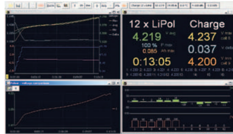
Die Software ist auch ein Analysetool. Hier kommen (nur) zur Demo fast alle Darstellungsmöglichkeiten zur Gegenüberstellung am Beispiel einer 12s-25 A-Fast-Reflex-Ladung. Links das Ladediagramm, rechts das Daten-Display (umschaltbar), der Ladeverlauf auf eine Zelle normiert und die Balanceraktivitäten. Hier die Darstellung der Differenz in Millivolt zur mittleren Spannungslage und die Auslastung der einzelnen Balanceraktivitäten
