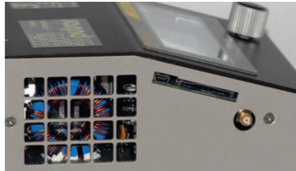
In der linken Gehäusesseite befinden sich die USB-Schnittstelle, der SD-Kartenslot und der optional erhältliche Bluetooth-Antennenanschluss
