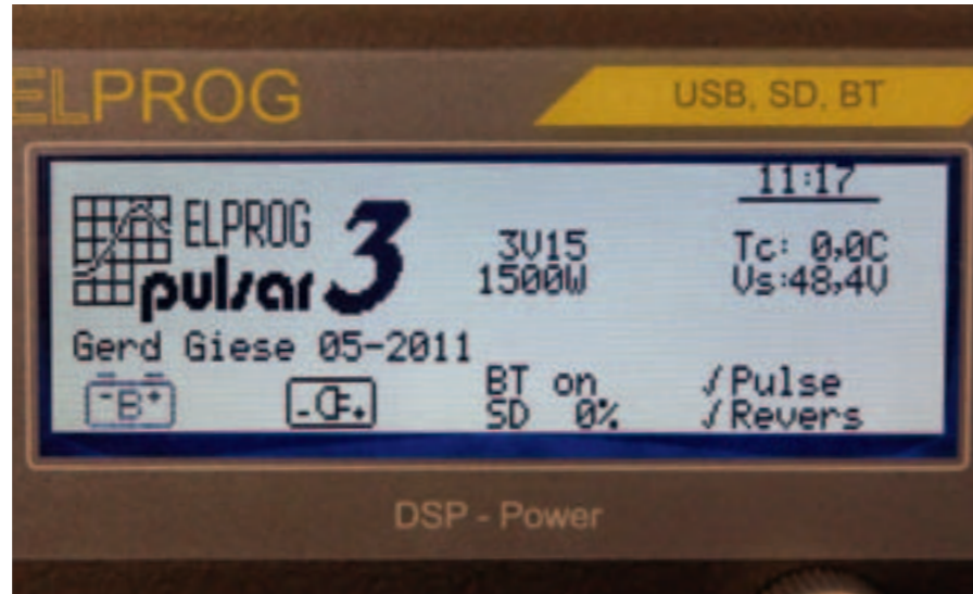
Das Startmenü mit der Abfrage zur Netzteil- oder der Batterieversorgung
