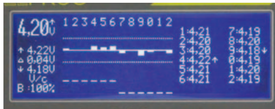
Die Balancer-Anzeige des Pulsar 3 ist, so glaubt der Autor, selbsterklärend. Die Differenzen der einzelnen Zellenspannungen kommen nur zu Stande, weil hier zwei einzelne 6s-Packs Verwendung fanden
