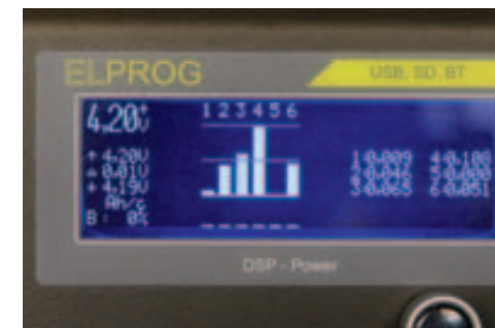
Eine Demonstration zur Genauigkeit der Balanceranzeigen. Bei der Entladung (helles Display), mit aktivierten Balanceraktivitäten, werden bis zu 0,136 Amperestunden (Z5) ausgeglichen. Was passiert jetzt beim Laden (dunkles Display)? Richtig: der Energiehaushalt zu den Balancerstufen zeigt ein exaktes Spiegelbild. Z5 beim Entladen = 0,136 Amperestunden, beim Laden jetzt 0,0 Amperestunden, und so weiter
