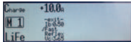
„Mode & Akku“: Der Akkutyp, der Prozess, die maximale Höhe des Balancerstromes, Fast, Reflex und die maximale Zellenspannung lassen sich konfigurieren
