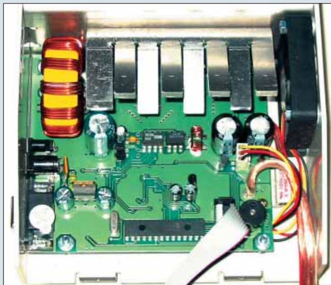
Aufgeräumter sauberer Aufbau: rechts der Lüfter hinten der gefä- cherte Alu-Kühlkörper
